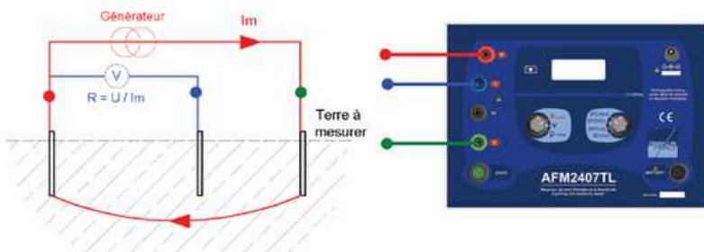
Mesurer la résistivité du sol permet de dimensionner les réseaux de terre de type A et/ou type B selon la la norme IEC / NF EN 62305-3
