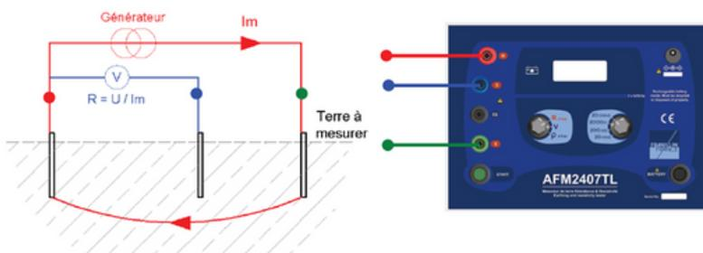
La medición de la resistividad del terreno permite dimensionar redes de tierra tipo A y/o tipo B según la norma IEC/NF EN 62305-3.
