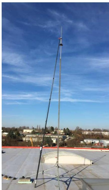
Esta pértiga telescópica asociada con la caja de prueba alámbrica AFV0050T, permite controlar el buen funcionamiento de los pararrayos **Active1D®** y **Active2D®** directamente en sitio (verificación inicial, verificaciones periódicas según norma NFC 17-102 y textos vigentes, mantenimiento,...).
