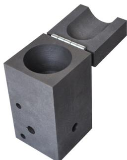
Les moules ARGOS, de la gamme ARGOSWELD® sont utilisés pour la réalisation de soudures aluminothermiques entre matériaux cuivre/cuivre, cuivre/acier, aluminium/aluminium sans aucune source d'énergie extérieure ou source de chaleur.
