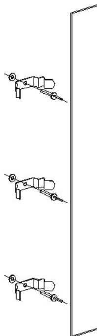
Les clips inox permettent de fixer les conducteurs de type feuillard acier galvanisé 33,5x3mm sur tout type de support à l'aide de rivet pop étanche de Ø4mm (AFH0075RP), vis à frapper (AFH0075RP), cheville expansion (AFH8050CE), de vis autoforante Ø3,9mm, Spit ou vis Ø4mm max.
