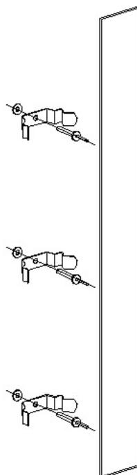
Les clips inox permettent de fixer les conducteurs de type feuillard aluminium 30x3mm sur tout type de support à l'aide de rivet pop étanche de Ø4mm (AFH0075RP), vis à frapper (AFH0075RP), cheville expansion (AFH8050CE), de vis autoforante Ø3,9mm, Spit ou vis Ø4mm max.
