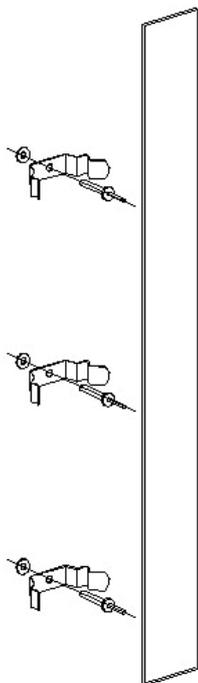
Les clips inox permettent de fixer les conducteurs de type feuillard cuivre 27x2mm sur tout type de support à l'aide de rivet pop étanche de Ø4mm (AFH0075RP), vis à frapper (AFH0075RP), cheville expansion (AFH8050CE), de vis autoforante Ø3,9mm, Spit ou vis Ø4mm max.
