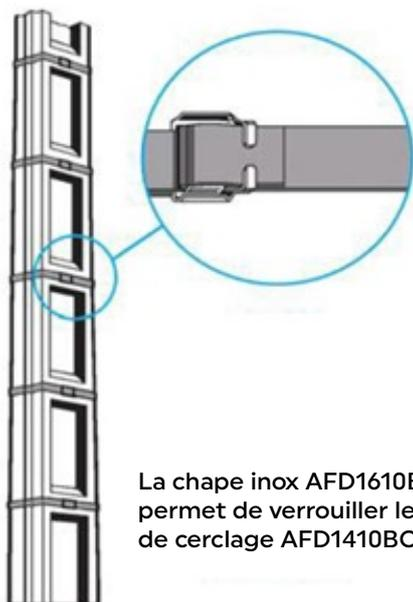
La chape inox AFD1610BC permet de verrouiller le feuillard de cerclage AFD1410BC.
