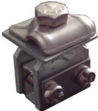
Ces attaches permettent de fixer les conducteurs ronds Ø8 ou 10mm sur des supports métalliques de type cornière, pylône ou charpente métallique. Elles peuvent également être utilisées pour réaliser des liaisons équipotentielle entre masses métalliques. Les conducteurs ronds Ø8 et 10mm sont maintenus en pression au niveau de la partie supérieure de cette pièce. La partie supérieure peut être pivotée sur 360°.
