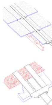
L'espacement entre chaque fixation sera déterminé selon la norme d'installation applicable (NFC 17102 ou NF EN 62305-3).
