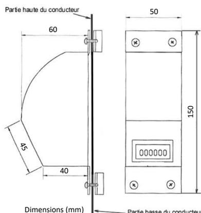
El contador AFV1007CF sirve para contabilizar los golpes de rayo que circulan en la bajadas asociados a un sistema de protección contra el rayo.
