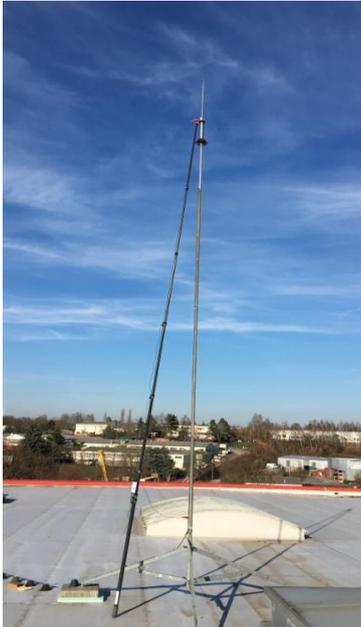
Cette perche télescopique associée au boîtier de test filaire (AFV0050TT), permet de contrôler le bon état de fonctionnement des paratonnerres Active 1D et Active 2D sur site (vérification initiale, vérifications périodiques selon norme NFC 17-102 et arrêts en vigueur, maintenance,...).
