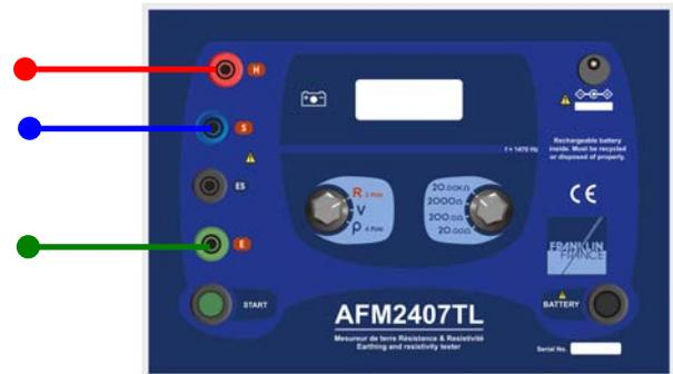
En este método una corriente de una frecuencia de 1470 Hz está inyectada en el terreno por un generador integrado en el telurometro. Por una medición de alta precisión, se puede determinar la resistencia de tierra por la ley de Ohm.
