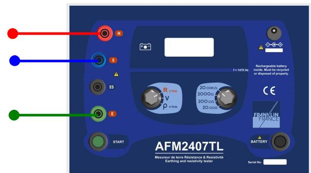
Dans cette méthode un courant ayant une fréquence de 1470 Hz est injecté dans le sol par un générateur intégré dans l'appareil. Par une mesure de tension à un endroit donné, il est alors possible de déterminer la résistance de terre par une simple Loi d'Ohm.
