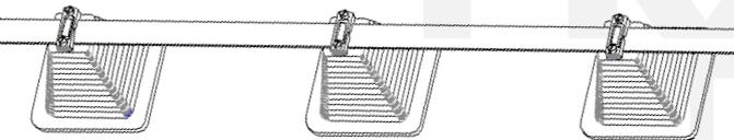
Ces plots permettent de fixer les conducteurs méplats ou ronds en toiture sans nuire à l'étanchéité. Il peut également être installé des toitures végétalisées ou gravillonnées.
