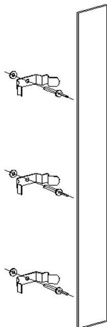
Les clips inox permettent de fixer les conducteurs de type feuillard cuivre 27x2mm sur tout type de support à l'aide de rivet pop étanche de Ø4mm (AFH0075RP), vis à frapper (AFH0075RP), cheville expansion (AFH8050CE), de vis autoforante Ø3,9mm, Spit ou vis Ø4mm max.
