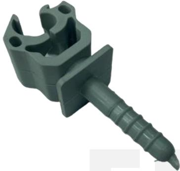
Ces attaches permettent de fixer les conducteurs ronds sur support béton. Les conducteurs ronds  $\varnothing$  8mm sont maintenus en pression au niveau de la partie supérieure enclipsable de cette pièce. La base est équipée d'une cheville  $\varnothing$  8mm.
