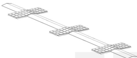
Ces brides sont utilisées essentiellement pour fixer les conducteurs de type feuillard cuivre étamé 27x2mm et aluminium 30x3mm sur les terrasses à revêtements étanches (étanchéité bitumineuse). Chaque bride doit être chauffée pour être parfaitement soudée au support.
