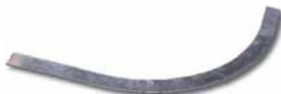
Este codo preformado de pletina de cobre estañado conforme con la norma NF EN 62561-2, permite evitar los codos bruscos en los conductores de bajante hacia la tierra.
