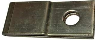
Esta fijación permite interconectar los conductores de tipo redondo de conexión o de bajante con las puntas captadoras de una jaula enmallada. La interconexión con los conductores de tipo pletina cobre estañado 27x2mm, acero inox 30x2mm, aluminio 30x3mm, acero galvanizado 33,5x3mm se hace por apretamiento de la punta captadora. El cuerpo esta perforado  $\varnothing$  11mm con el fin de facilitar la conexión con un tornillo M10.
